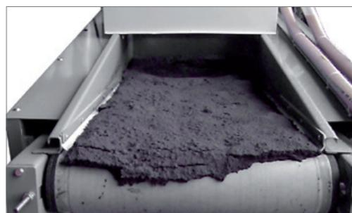
Der **Schlamm** wird von der Anlage im nahezu trockenen Zustand ausgeschieden.
