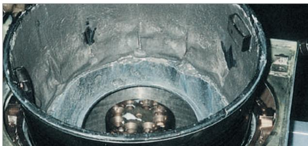
Der **Schlammeinsatz** des Trommelseparators nimmt bis zu 5 Liter nahezu trockenen Schlamm auf. Der Einsatz lässt sich schnell wechseln und dank der Schnellverschlüsse problemlos reinigen.
